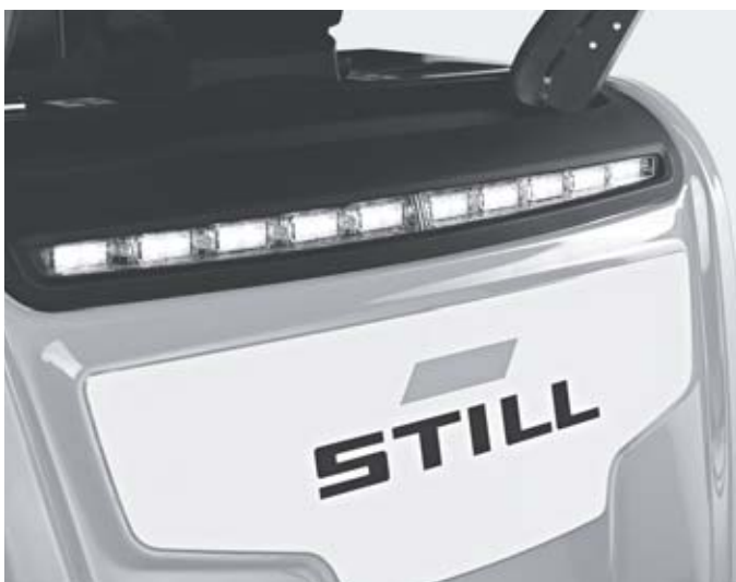
Intelligentes LED-Tagfahrlicht erhöht die Sichtbarkeit des Fahrzeugs und signalisiert einen geringen Batteriestatus
