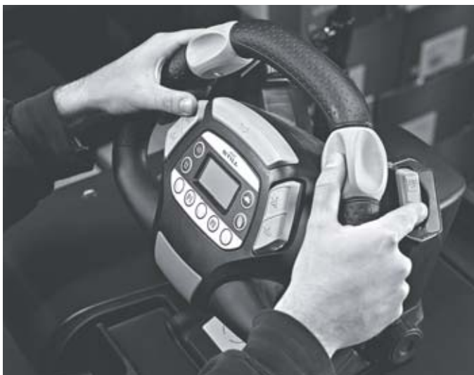
Einzigartiges STILL Easy Drive Lenkrad für bestes Fahrgefühl und Bedienung aller Funktionen ohne Umgreifen
